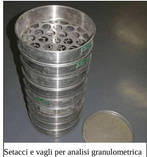
Il provino sottoposto all'analisi granulometrica è disaggregato tramite essiccazione e vagliato ad aperture via via decrescenti. La prova può essere eseguita anche ad umido tramite sottrazione del peso iniziale secco e rimanenza dopo lavaggio al setaccio 0.075mm.
