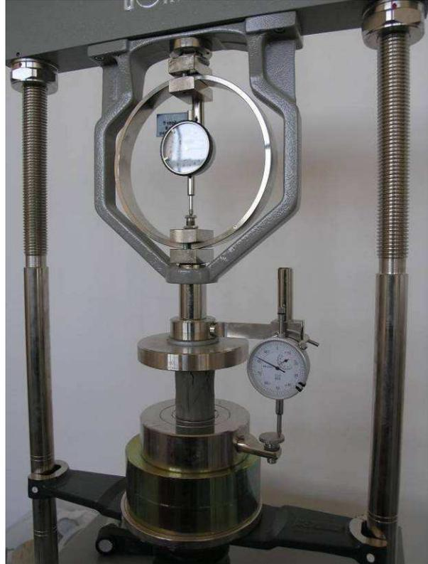
Moltiplicando il numero di divisioni per la costante di taratura dell'anello dinamometrico e dividendo per la sezione media del provino si ottiene la tensione di deformazione. Il valore di riferimento è ottenuto dalla media di almeno due valori massimi di tensione, ottenuti per due provini diversi; esso è proporzionale alla coesione non drenata ( $C_u$ ) del campione sottoposto a prova.
