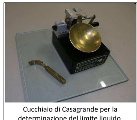
assorbire prima di passare da un comportamento del terreno da plastico a liquido. Il successivo passaggio di stato, con diminuzione del contenuto d'acqua, da un comportamento plastico ad uno semisolido costituisce il limite liquido. Sulla base dei diversi comportamenti dei vari terreni introducendo l'indice di consistenza si possono correlare i risultati dei limiti di Atterberg al comportamento meccanico del campione
